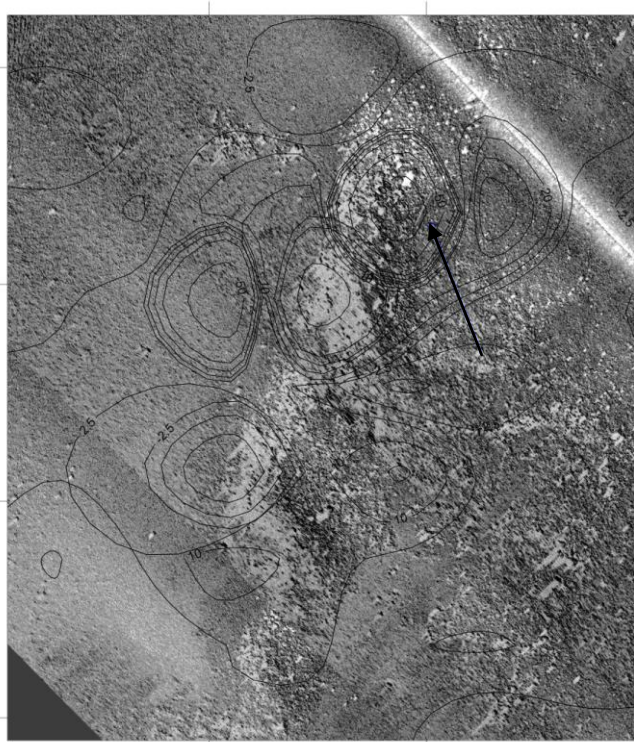
Rys.5.7. Przykład obiektu (torpeda o masie magnetycznej ok. 1,5 tony) zalegającego na dnie z nałożonymi wartościami anomalii pola magnetycznego w badanym rejonie
